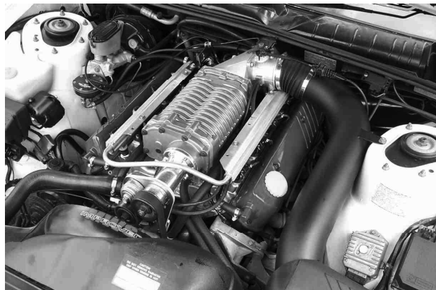
Rootsovo dmychadlo – uložení na motoru [9]
